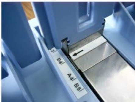
3. ปรับแผ่นรองให้ตรงกับขนาดของสำเนา
