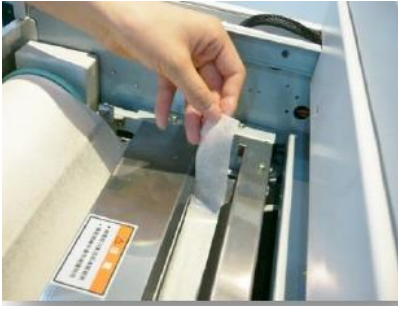
9. นำปลายมาสเตอร์ที่ถูกตัดออก
