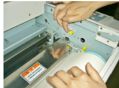
6. สอดปลายมาสเตอร์ใต้แกนเหล็กให้เลยฝาครอบของชุด cutter
