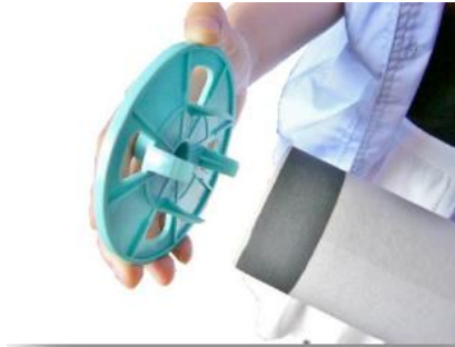
1. รูปวงล้อสำหรับประกบซ้าย-ขวาม้วนมาสเตอร์
