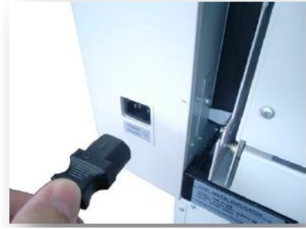
จุดต่อปลั๊กสายไฟ
