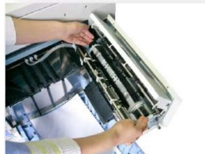
4. นำแกนที่พันแผ่นมาสเตอร์ใช้งานแล้วออก
